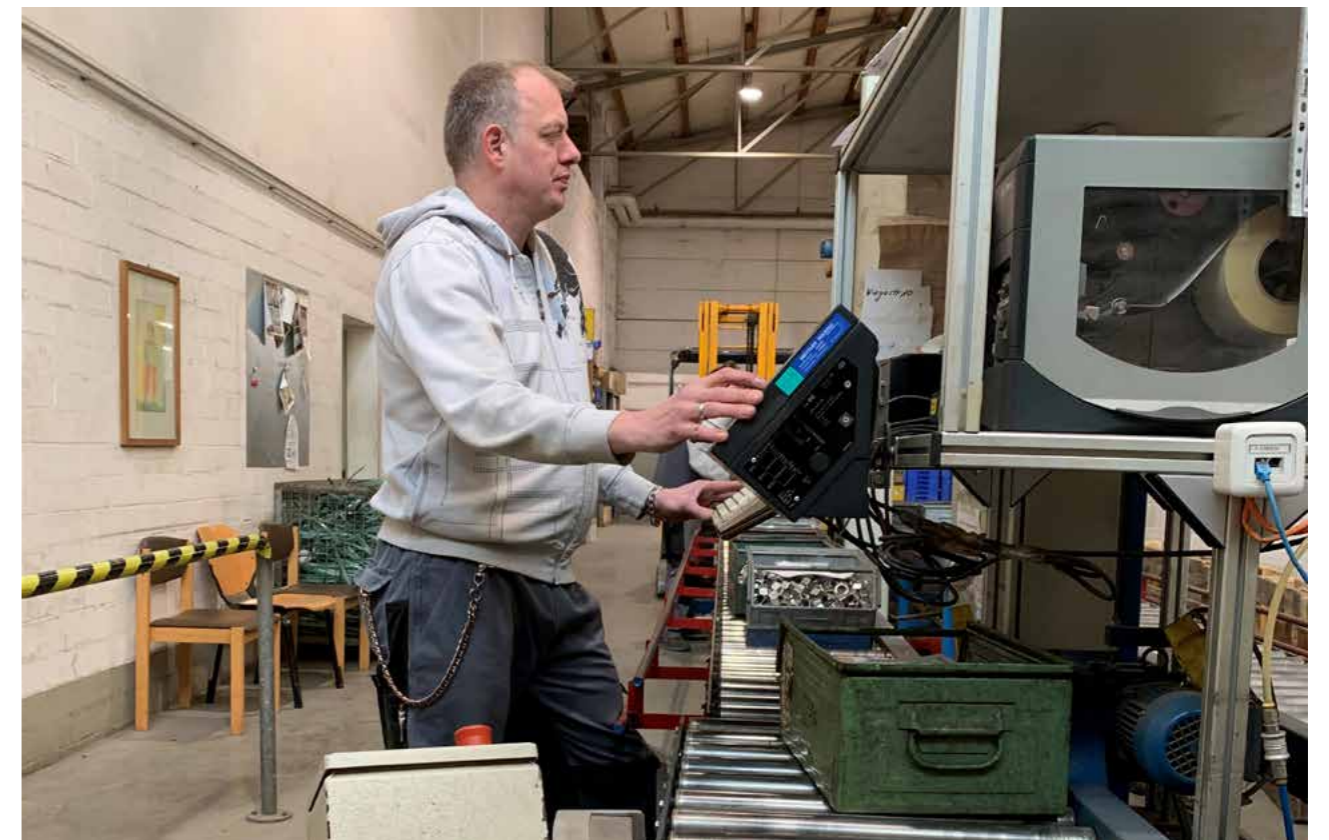
Werkstatt Basan: Maik Böhme ist an seinem PC-Arbeitsplatz an der Wiegestraße mit der Auftragsfirma verbunden, dadurch kann er direkt die geforderten Mengen abwägen.
